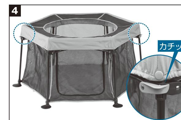
2カ所のロックが「カチッ」と音がするまで、クロスフレームをしっかりと引き上げてください。
